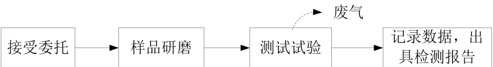
图 15 燃烧热值试验流程及产排污环节图
